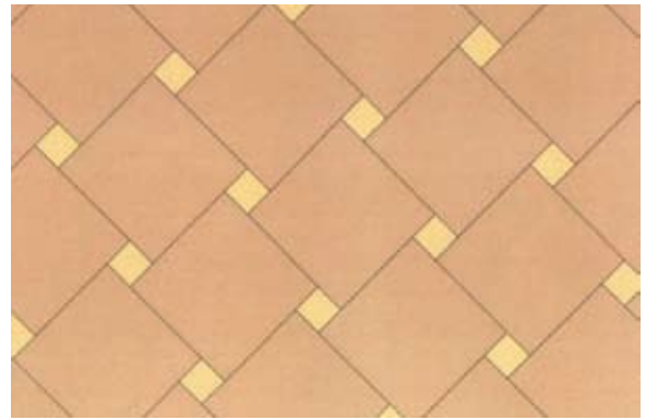
C102 Composizione obliqua a fughe di quadrati di colore contrastante, con l'impiego di quadrati 28,5x28,5 di colore rosato e di quadrati 7x7 di colore paglierino.
