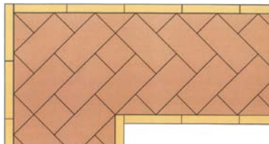
B299 Cornice a spina di pesce, invertita e raccordata agli angoli con motivo rettangolare, con l'impiego di tavelle 29x14,5 di colore rosato e bastonetti 29x5 di colore paglierino a correre, oltre a quadri 14,5x14,5 rosato ad angoli.
